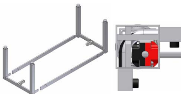
6.1.4 Ahora montar los dos largueros frontales. Importante. Empujar los largueros frontales y laterales contra las patas antes de apretar los tornillos. Apretar los tornillos.
