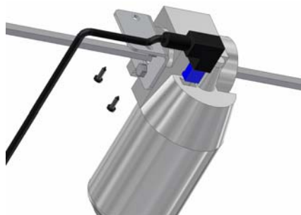
6.1.1 Colocar el eje hexagonal en el motor.
